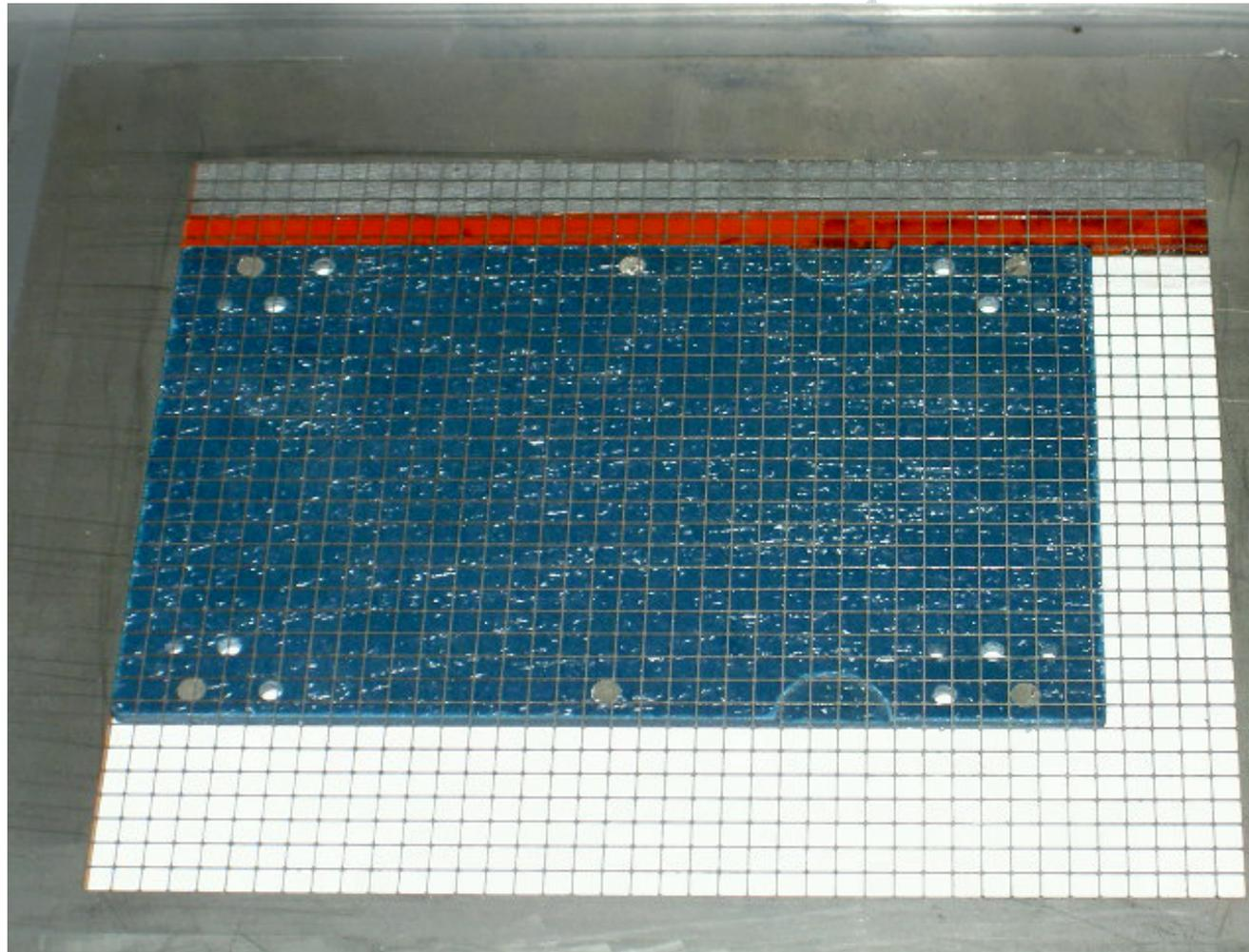
4.4.2 設定載板放置的基準點：當載板與鋼板的相對位置確認後，即可以設定載板放置的基準點。可以準備 2 支平整的板材沿著載板邊緣黏貼牢固即可。請參考 **FIGURE 6. 設定載板放置的基準點**
