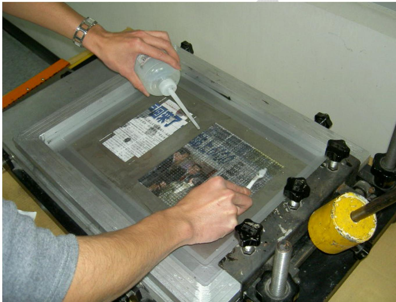
4.3 若為使用過之 808 粘性載板重新塗膠，則需先進行載板除膠作業。請參考 **FIGURE 4. 808 膠鏟除作業**。
